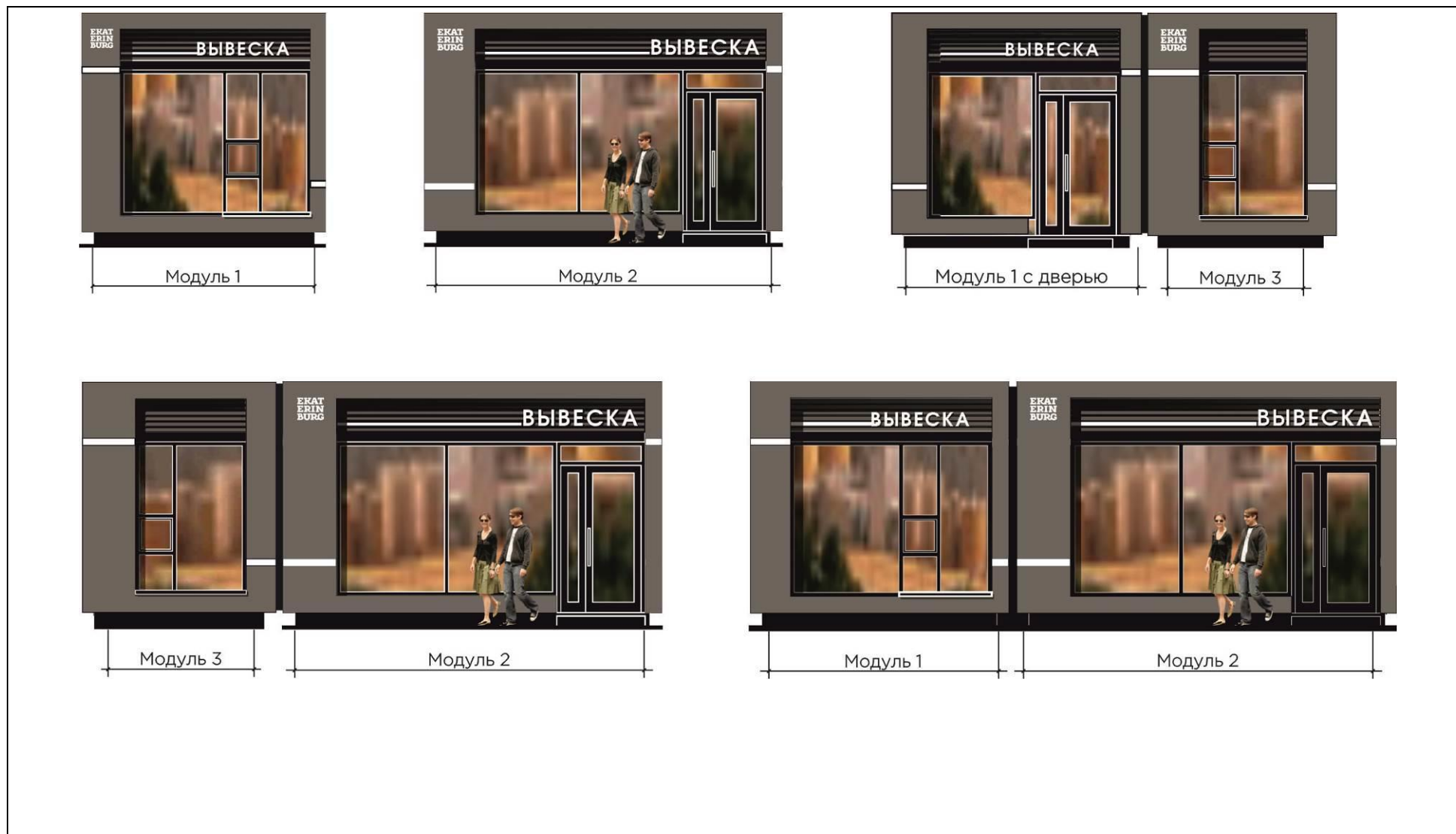
Рисунок 9 – Варианты стыковки модулей
