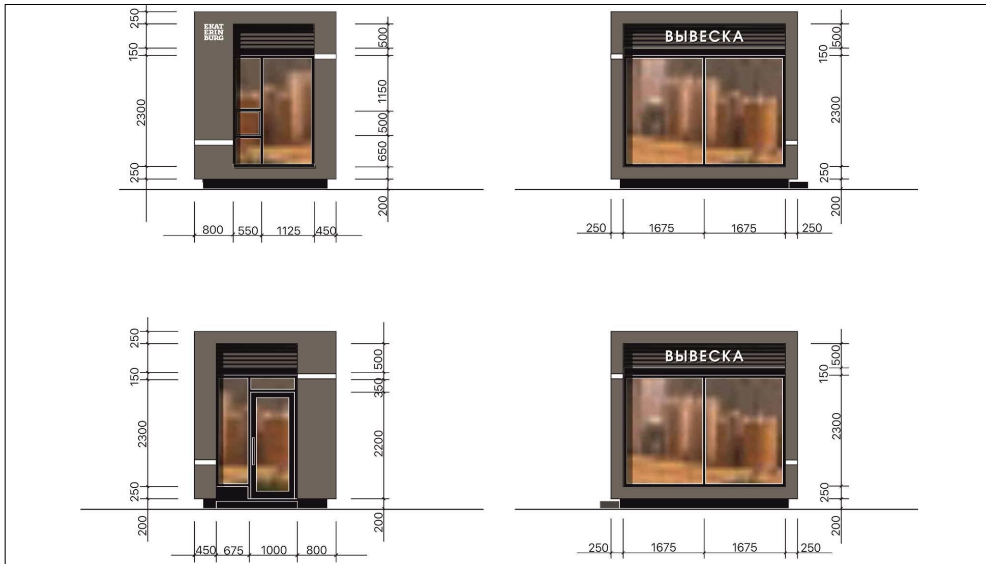
Рисунок 8 – Развертки фасадов модуля 3
