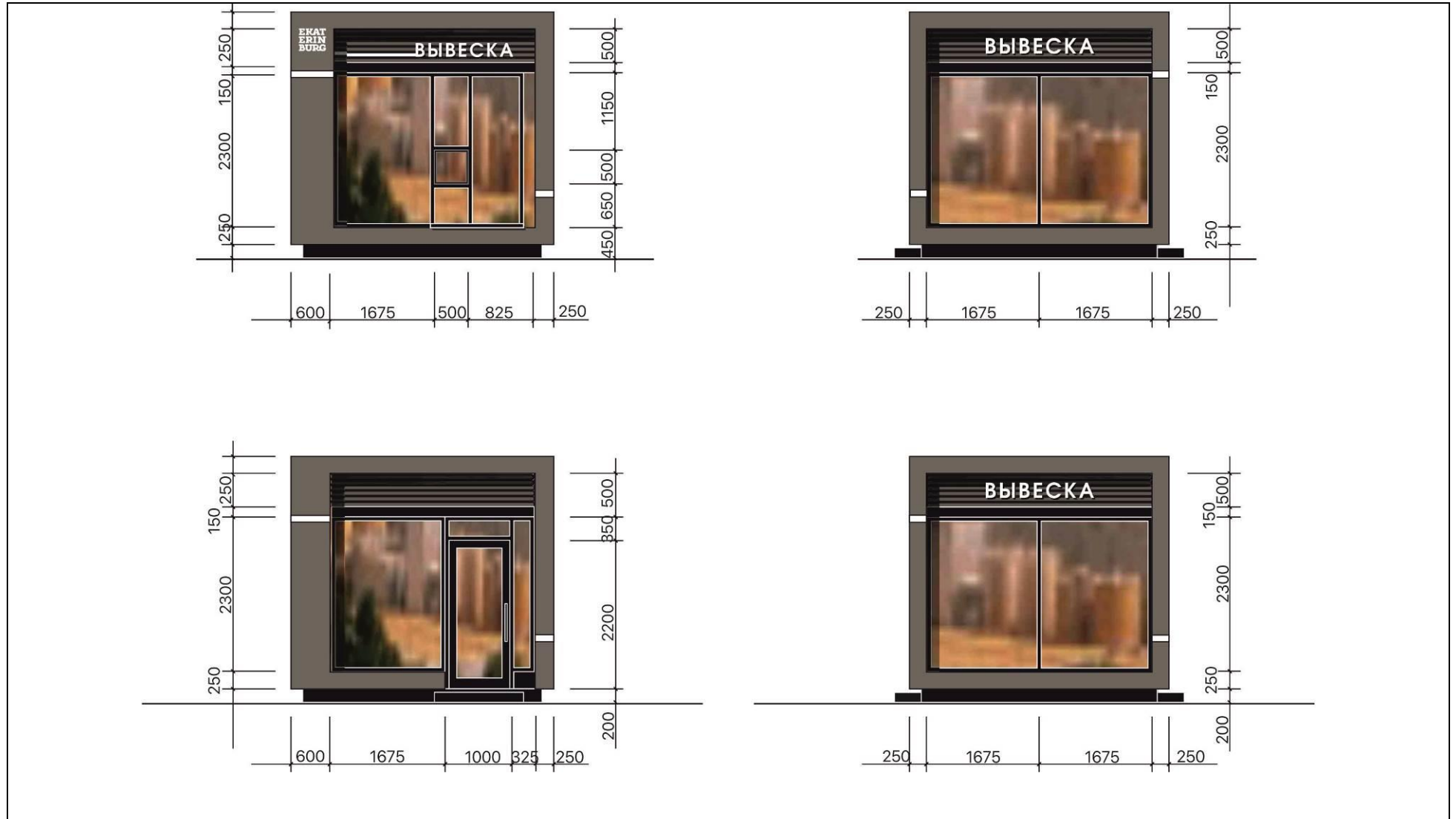
Рисунок 2 – Развертки фасадов модуля 1 с торговым окном
